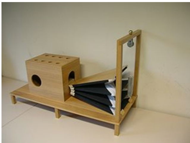
Figure 1: Saarland University大学于2007-2009年重现的Kempelen发声器。
